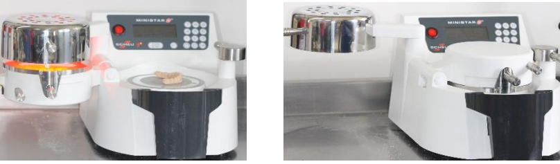
Şekil 3. Termoform plağın ministar cihazında model üzerinde şekillendirilmesi
