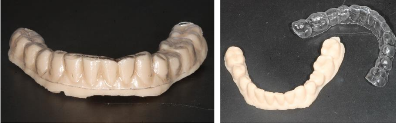
Şekil 6. Üretilen 3D model ve şeffaf plak
