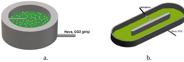
Şekil 1. Açık fotobiyoreaktörlerin şematik gösterimi a) Dairesel fotobiyoreaktör, b) Karusel tipi fotobiyoreaktör [1]
