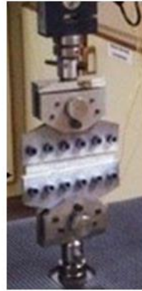
Şekil 5. Düzlem çekme deneyi [7]
