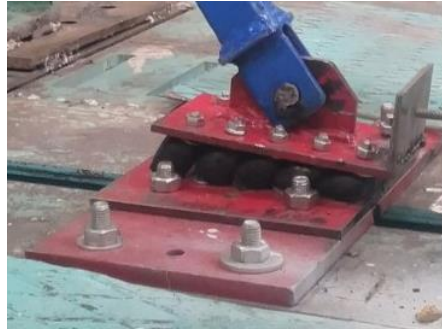
Şekil 10. Kauçuk sismik damperin deney sonundaki davranışı
