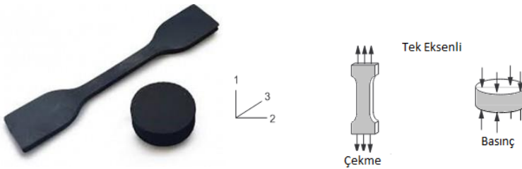
Şekil 3. Tek eksenli deney için kullanılan kauçuk malzemesi ve deney eksenleri.
