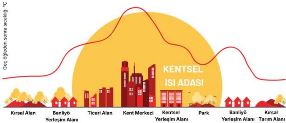
Şekil 1 Kentsel Isı Adası Şemasal Gösterimi Kaynak: World Meteorological Organization [WMO], n.d.
