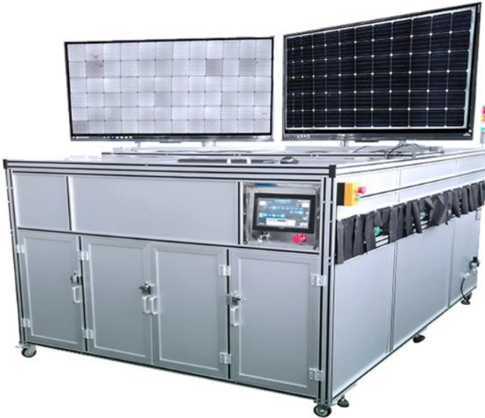
Şekil 12. Güneş paneli için Elektrolüminesans (EL) Testi [13]
