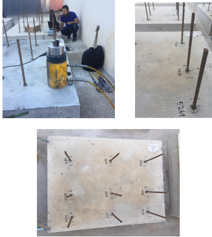
Şekil 9. Çekip Çıkarma Deneyleri
