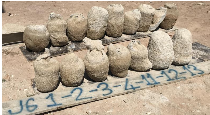
Şekil 2. Jet grout kolonlarının görünümü.
