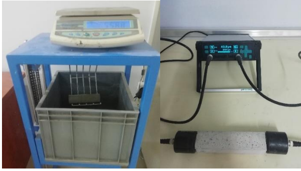
Şekil 3. Harçlara ait fiziksel özellik belirleme ve ultrases hızı ölçümü deneyi düzenekleri
