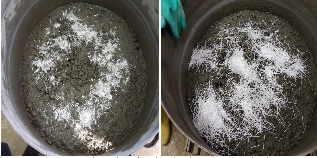
Şekil 2. Beton karışımlarına fiber donatıların ilave edilmesinden kesitler
