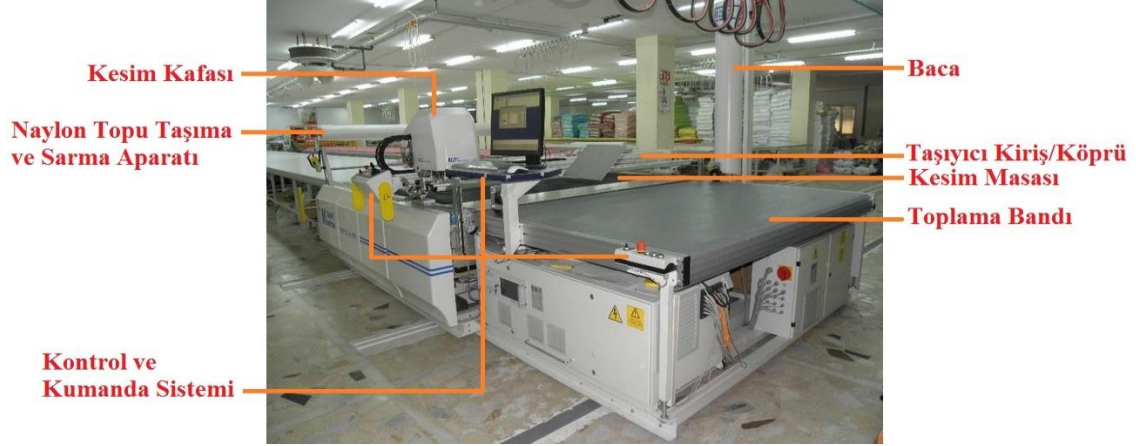
Şekil 5. Asssyst Bullmer Cutter Genel Görüntüsü ve Parçaları (Çetin, M.S., 2011)
