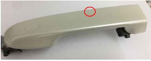
Şekil 9. 3. Hatalı kapı kolu
