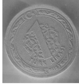
Şekil 1. Retrografik elastomerik sensörden alınan ham görüntü.
