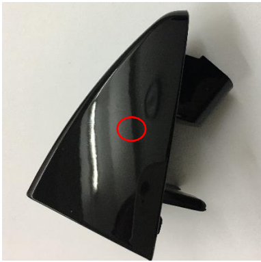
Şekil 10. 4. Hatalı kapı kolu
