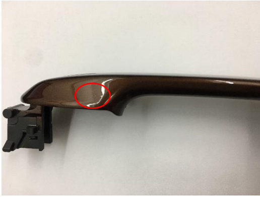
Şekil 5. 1. Hatalı kapı kolu
