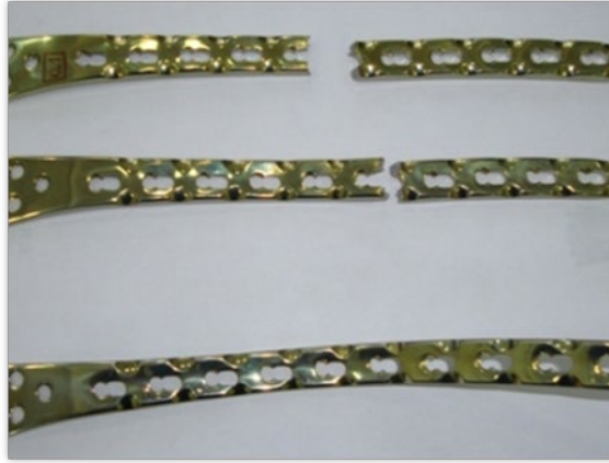
Şekil 3. Hasar görmüş plak implant örnekleri
