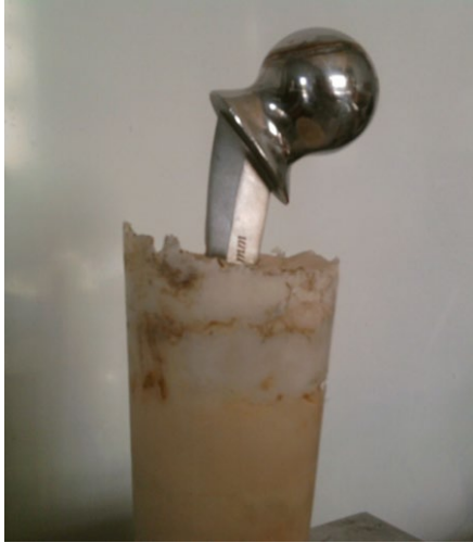
Şekil 5. (a) Hip Joint- Kalça implantı (kemik çimentosuna monte edilmiş), (b) Hip Joint vücut benzetimi ortam hazırlanması
