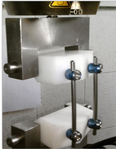
Şekil 4. ASTM F1717 test standardına göre yapılan bel implantı biyomekanik test düzeneği
