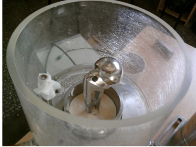
Şekil 5. (a) Hip Joint- Kalça implantı (kemik çimentosuna monte edilmiş), (b) Hip Joint vücut benzetimi ortam hazırlanması
