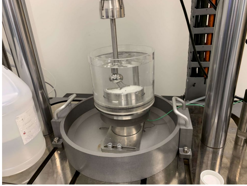
Şekil 6. ISO 7206 Hip Joint vücut benzetimi ortamı test düzeneği
