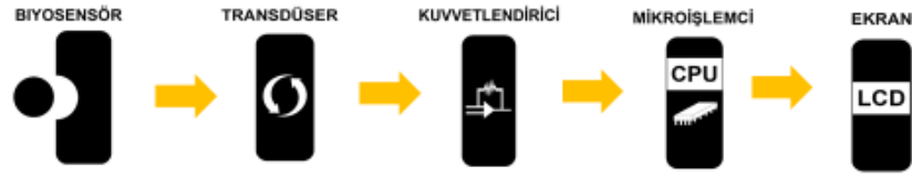
Şekil 2. Elektronik Devre Haline Getirilmiş Biyosensör Sisteminin Şematik Gösterimi
