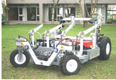
Şekil 4. Kivi Toplama robotu prototipi, (Scarfe vd., 2011)
